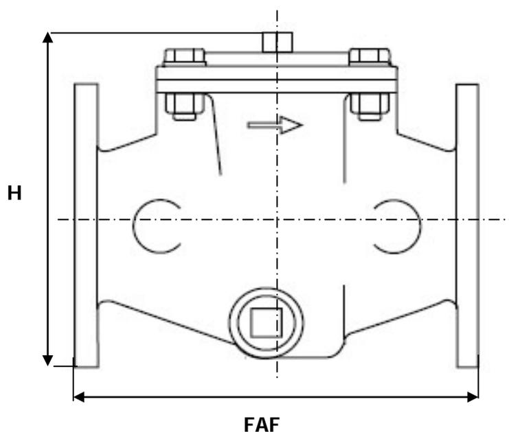
Bouchon de purge 1" 1/4 du DN40 au DN250
